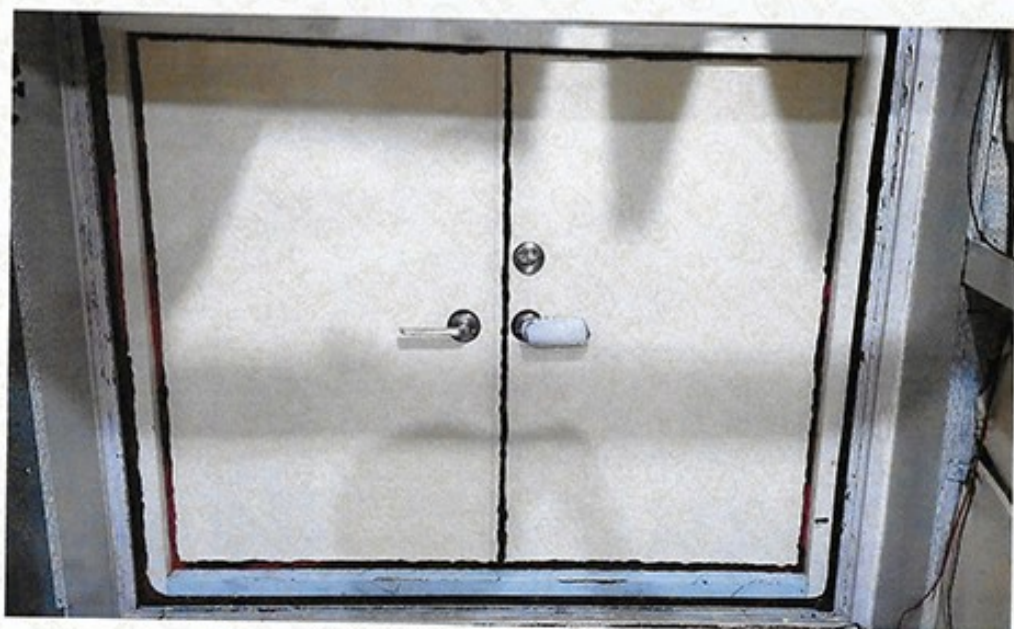
圖 1 試樣佈置圖 (無響室)
