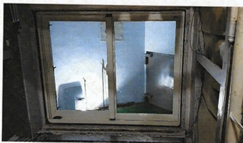
圖 1 試樣佈置圖 (無響室)
